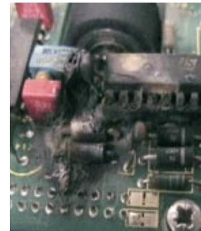
Schaden an Elektronik durch blitzbedingte Überspannungen
